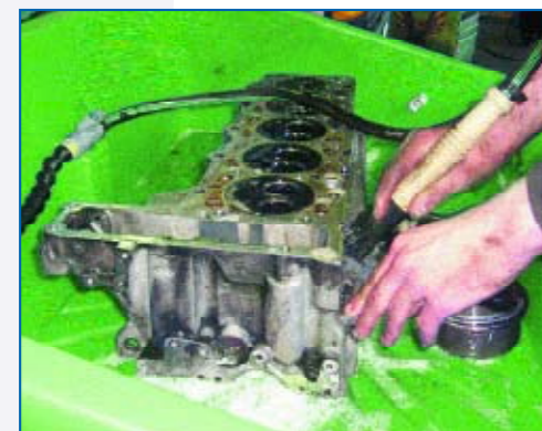
Anwendungsbeispiel: Entfernung von Fetten und Ölen von Aluminiumdruckguss.
